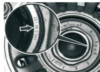
Производственный ном. / серийный ном. находится справа на балке оси, в направлении движения.
